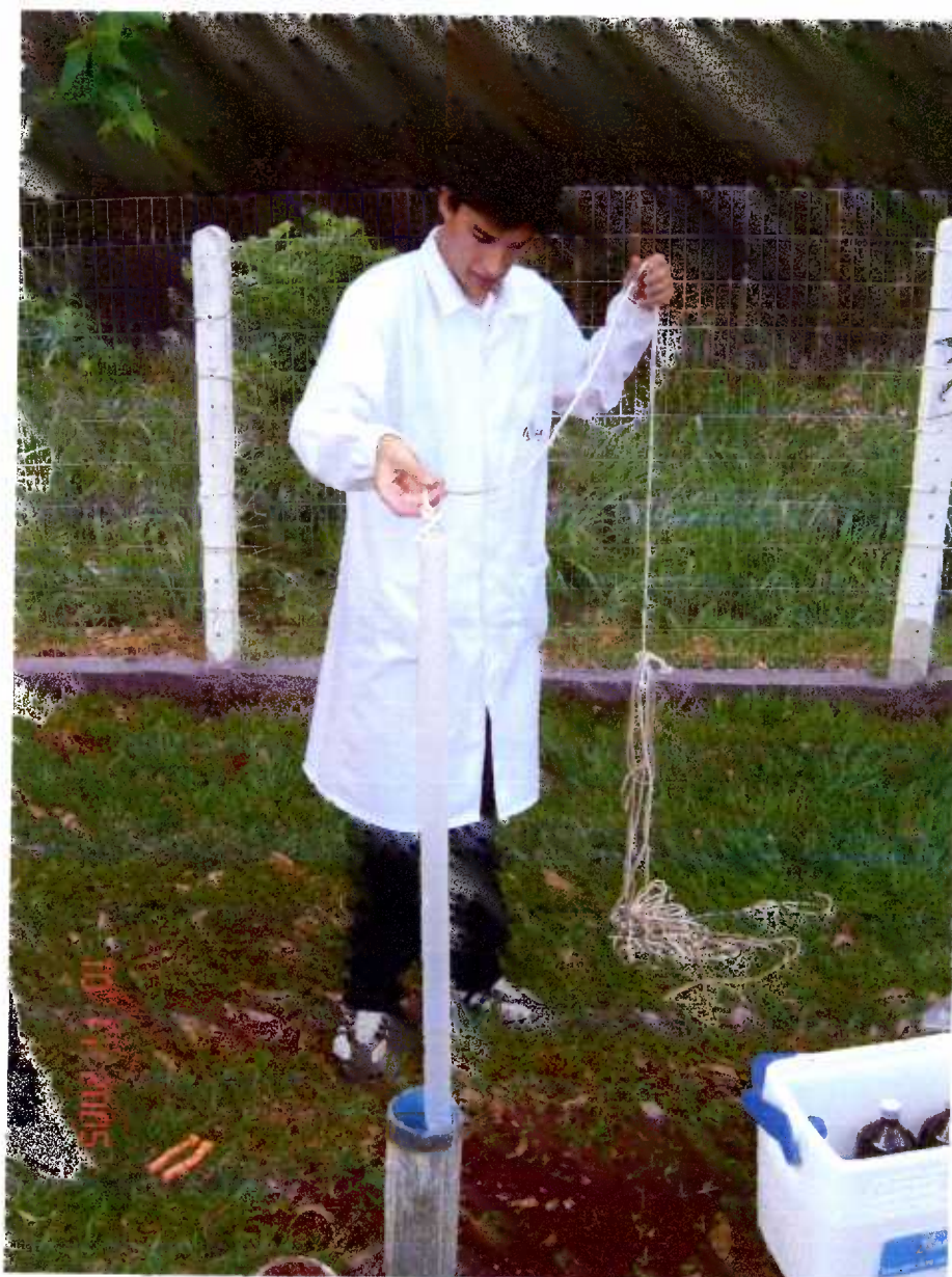
Figura 129 – Amostragem de água do poço de monitoramento a jusante das lagoas de tratamento, no aterro sanitário de Toledo-PR.
