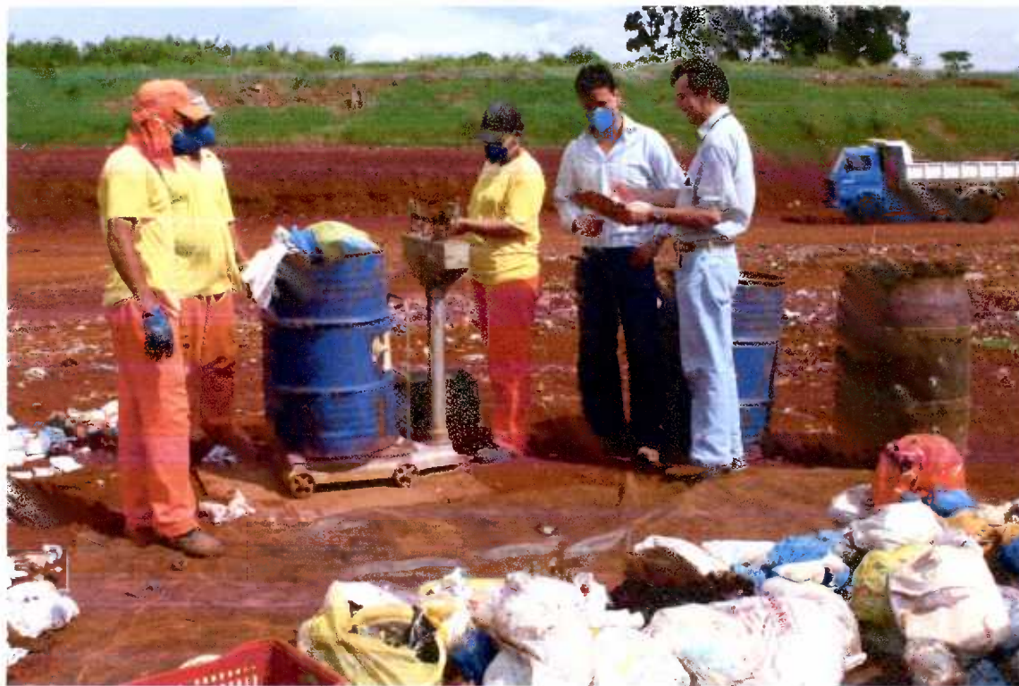
Figura 35 – Transcrição dos valores obtidos na pesagem dos tambores em uma planilha, para determinação dos parâmetros físicos do resíduo analisado.
