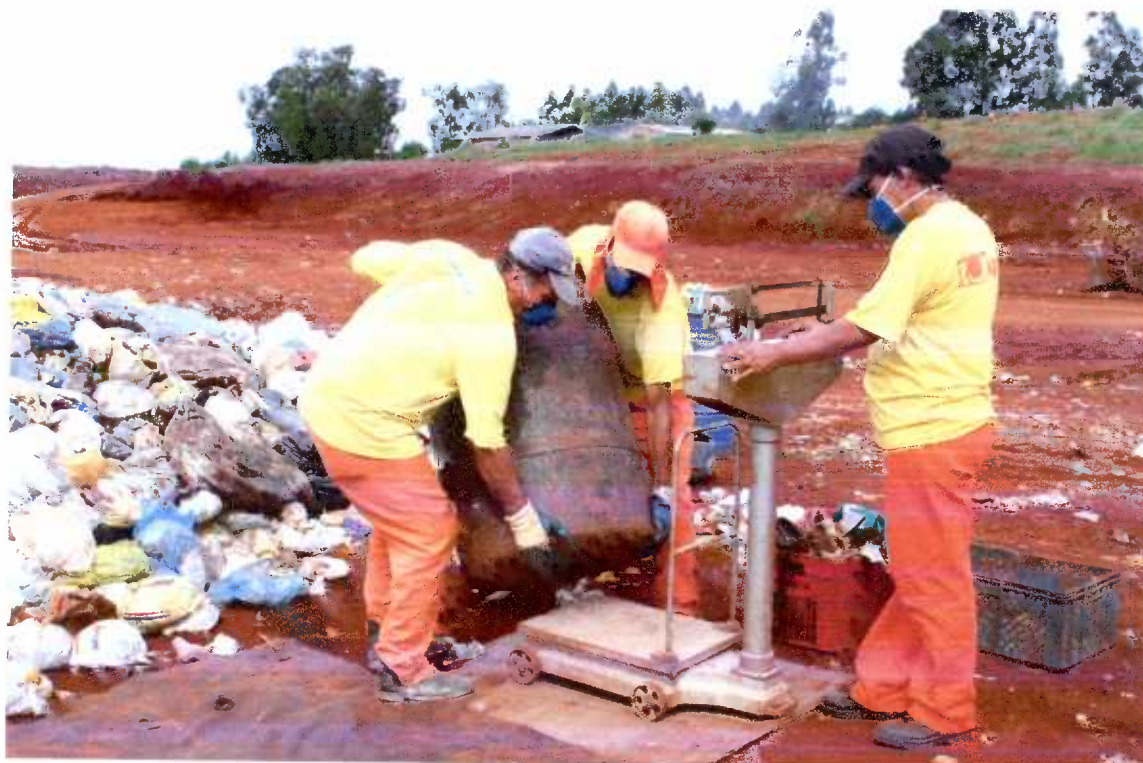
Figura 34 – Pesagem de cada tambor (diferentes tipos de resíduos) para a determinação da composição gravimétrica.
