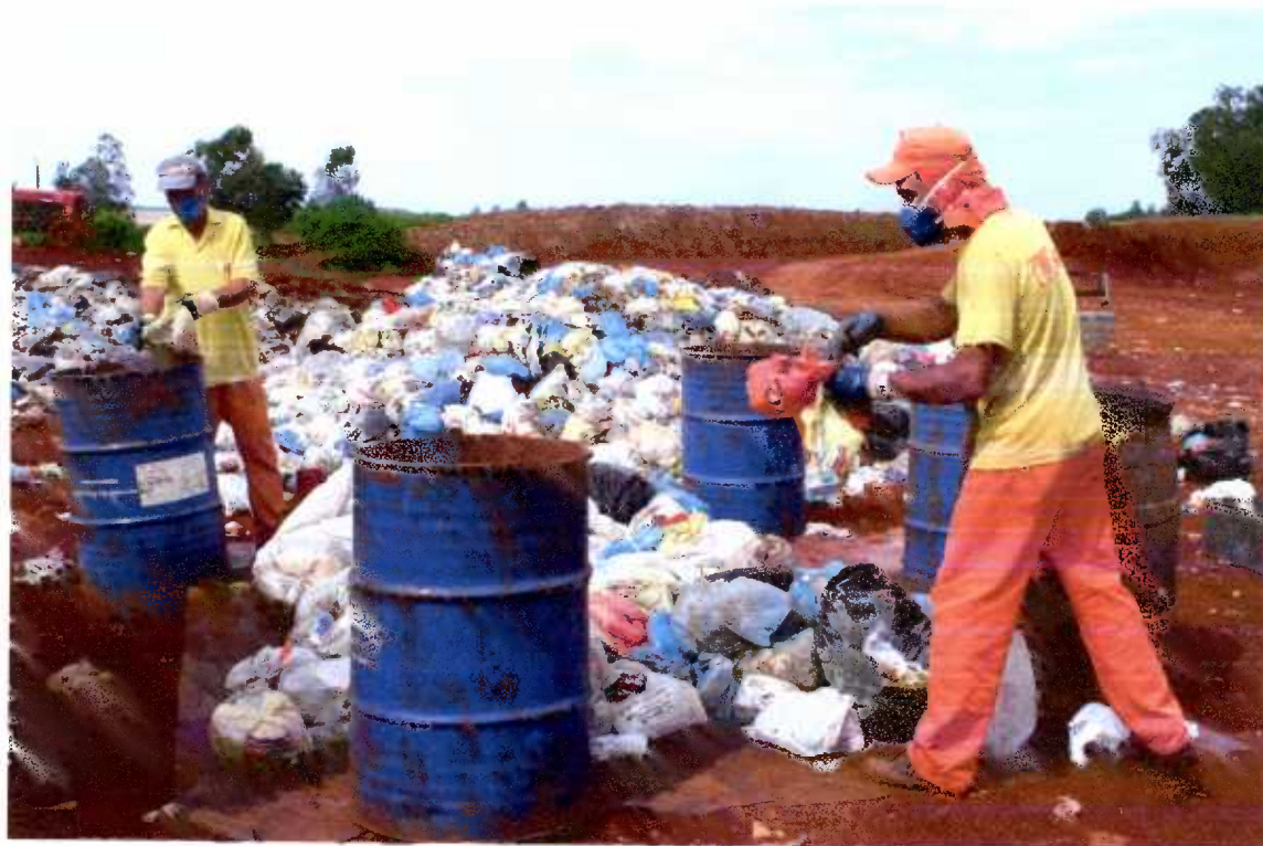
Figura 33 – Triagem dos diferentes materiais constituintes, da amostra de resíduos domiciliares.
