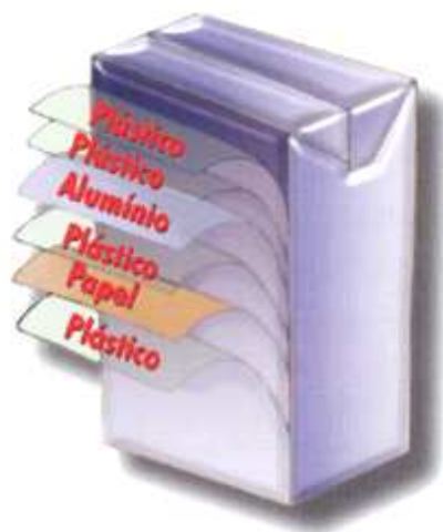
Figura 10: Constituição de uma embalagem longa-vida (PARANÁ, 2005).
