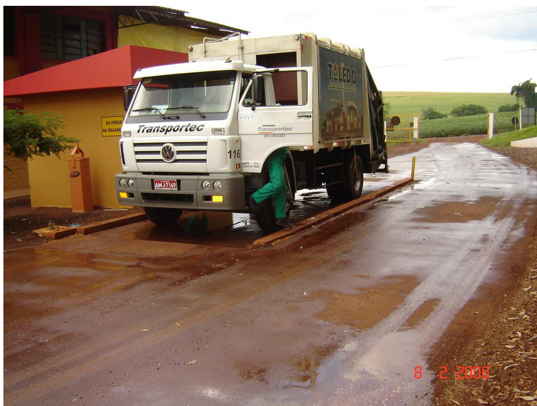
Figura 121 – Balança rodoviária para controle da entrada de resíduos sólidos no aterro sanitário municipal de Toledo-PR.
