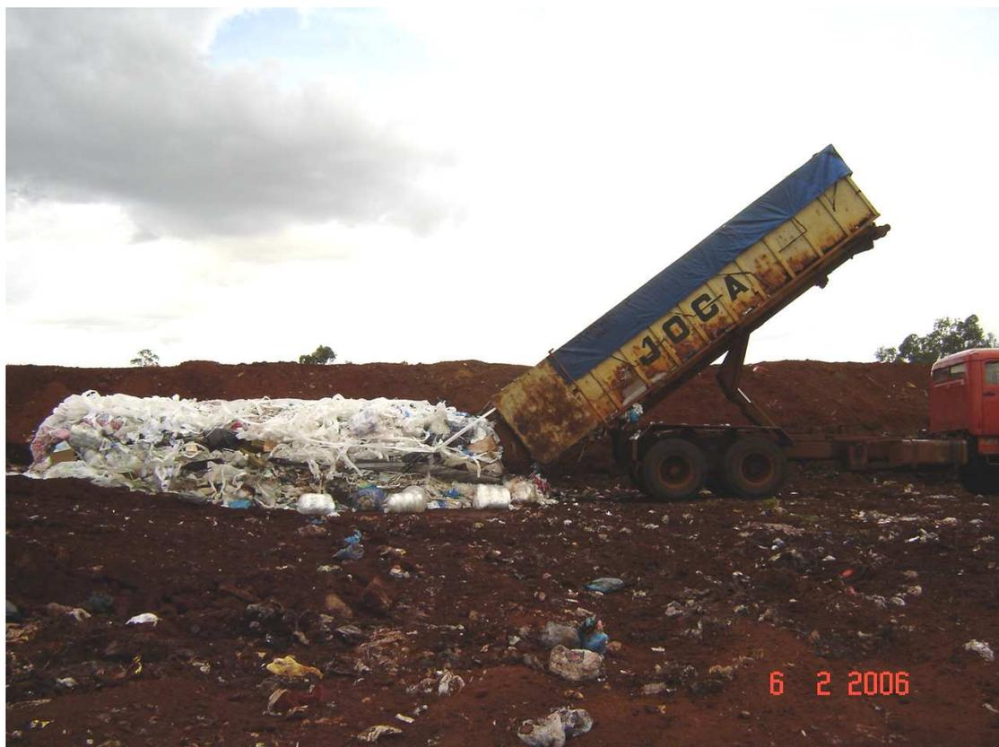
Figura 88 – Aspecto dos resíduos industriais, dispostos no aterro sanitário de Toledo-PR.
