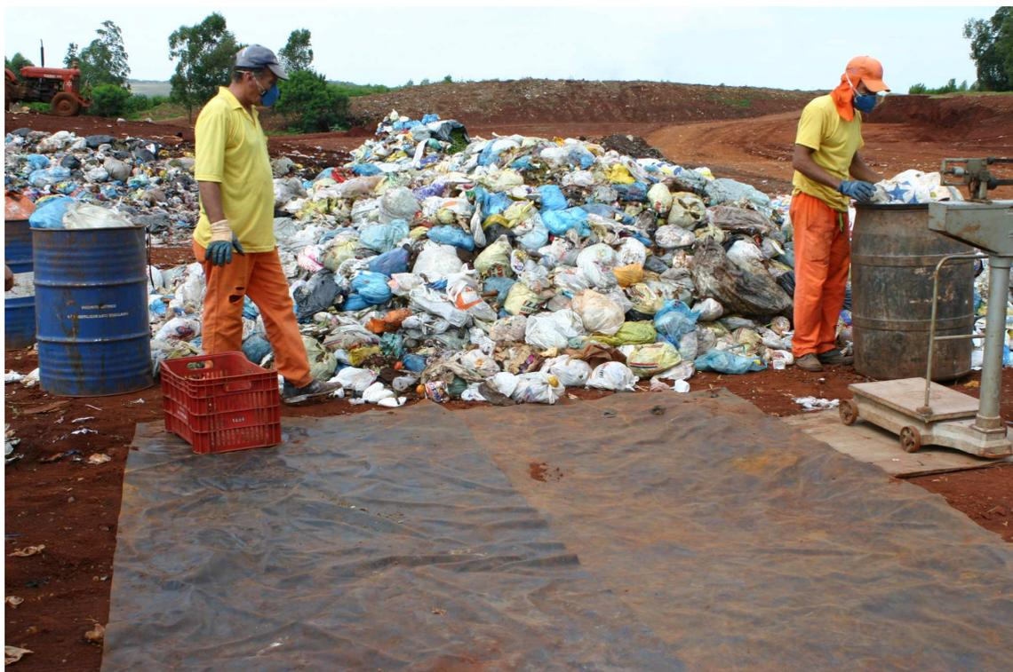
Figura 42 – Amostra de resíduos sólidos domiciliares sendo despejada sobre a geomembrana.
