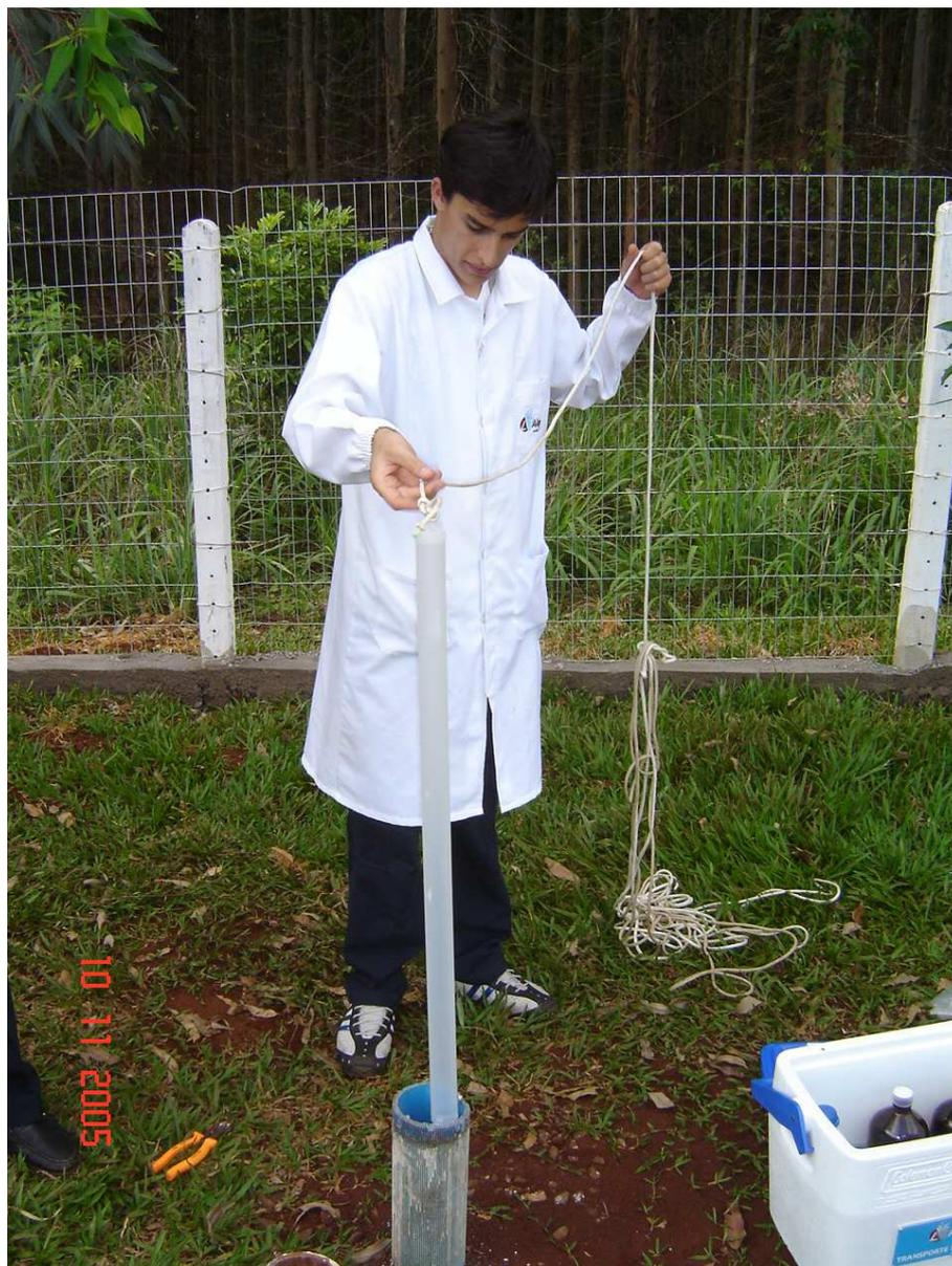
No aterro sanitário de Toledo-PR, os referidos poços fazem parte do sistema de monitoramento ambiental, e devem ser perfurados até a profundidade mínima de 30 metros, ou, até alcançar o nível do lençol freático. As amostras dos dois poços (1 a montante e 1 a jusante) são comparadas para verificar se há ou não, contaminação das águas subterrâneas.
