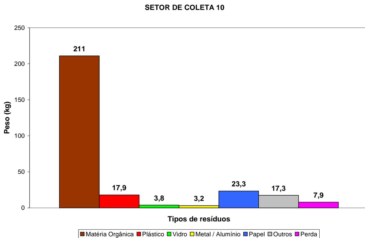
Figura 66 – Composição gravimétrica dos resíduos sólidos do Setor de Coleta 10.
